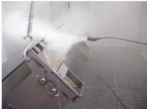
Weiter können Antox 400 und Gardoclean S 5104 direkt einem Hochdruckreinigungsgerät beigemischt werden. Antox 400 wird über die Dosierpumpe des Dampfstrahl- oder Hochdruckgerätes dem Wasser bzw. dem Wasser-Dampf beigegeben. Beim Austritt an der Lanze soll eine Konzentration von 3 bis 5 % erreicht werden.
