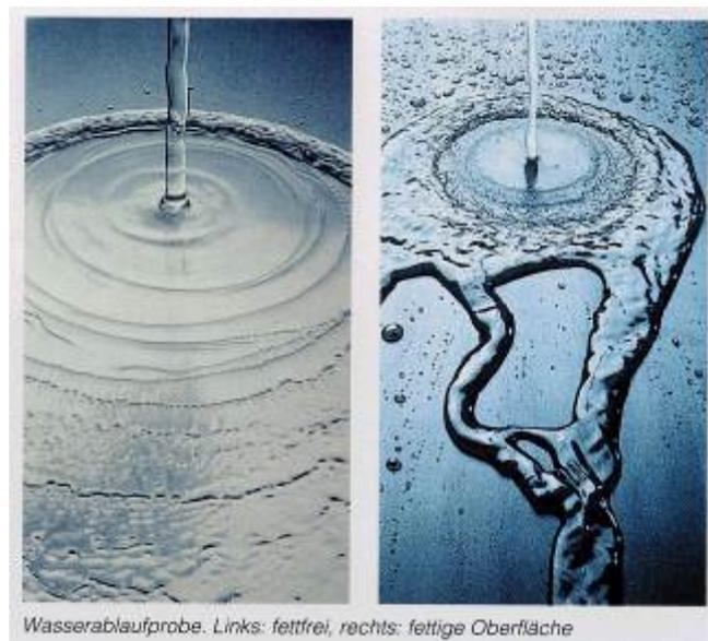
Wie das Entfetten einer Metalloberfläche durch Tenside abläuft
