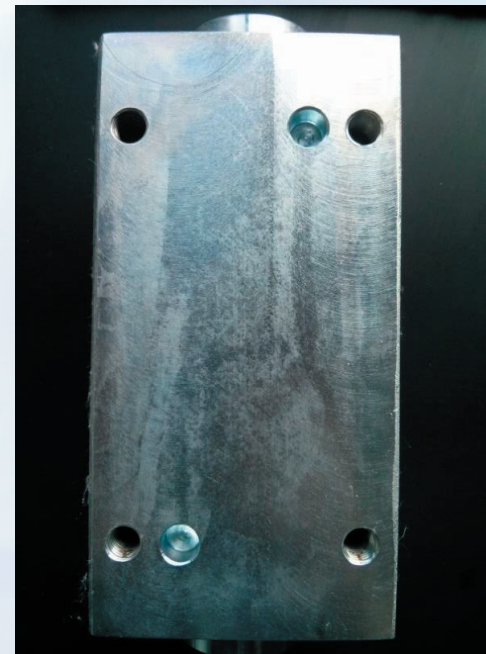
gefräster Oberfläche nach dem galvanisch Verzinken
